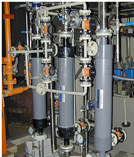
Liqui-Cel® Kontaktoren bei der effizienten Entfernung von Ammoniak aus Abwasser
