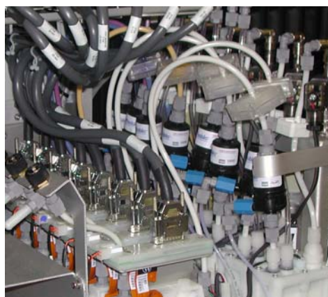
1 x 3 SuperPhobic® Kontaktoren installiert in einem Großformat Tintenstrahldrucker
