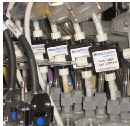
0.5 x 1 SuperPhobic® Kontaktoren installiert in einem Großformat Tintenstrahldrucker
